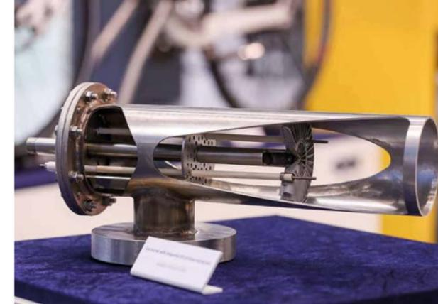
Die neue Brennertechnologie kommt aus dem 3-D-Drucker.
