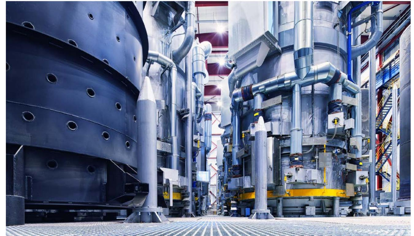
gieversorgung BILSTEIN GROUP. Neben den Druckluftkompressoren ist bei HUGO VOGELSANG auch die Glühe an die Wärmerückgewinnung angeschlossen. Damit sind die Potenziale der Wärmerückgewinnung weitgehend ausgeschöpft.
